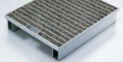
適用荷重：人荷重5.0KN/mおよびT-2クラスの荷重通過(低頻度)が可能。 骨材：球状セラミックス・天然石
