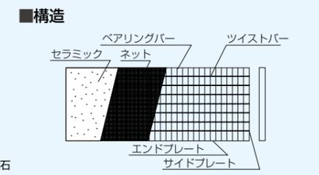
適用荷重：人荷重5.0KN/mおよびT-2クラスの荷重通過(低頻度)が可能。 骨材：球状セラミックス・天然石
